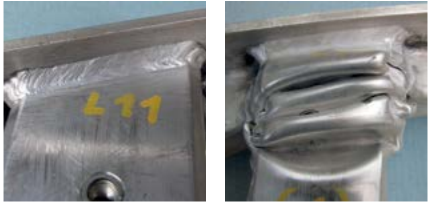
Abb. 4: Schweißverbindung Crashbox/Stoßfänger vor und nach dem Fallturmversuch
