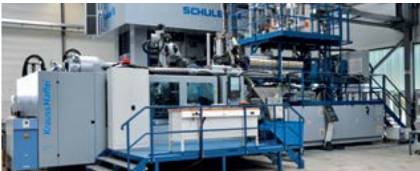
Spritzgießcompounder mit einer Schließkraft von 13.000 kN
