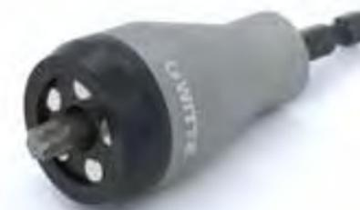
Der patentierte Schwerschraubenhalter ist mit fünf flexibel gelagerten Neodym-Magneten ausgestattet, die sowohl Linsenkopf- als auch Senkkopfschrauben fest fixieren. Der Sicherungsring im Halter verankert austauschbare Bits mit TORX 40-50 Antrieben.
