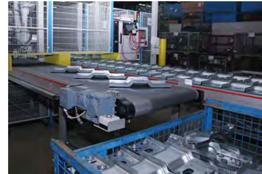
Am Standort Iserlohn wird erstmalig eine automatisierte Roboteranlage zum Buckelschweißen von Verbindungselementen eingesetzt.
