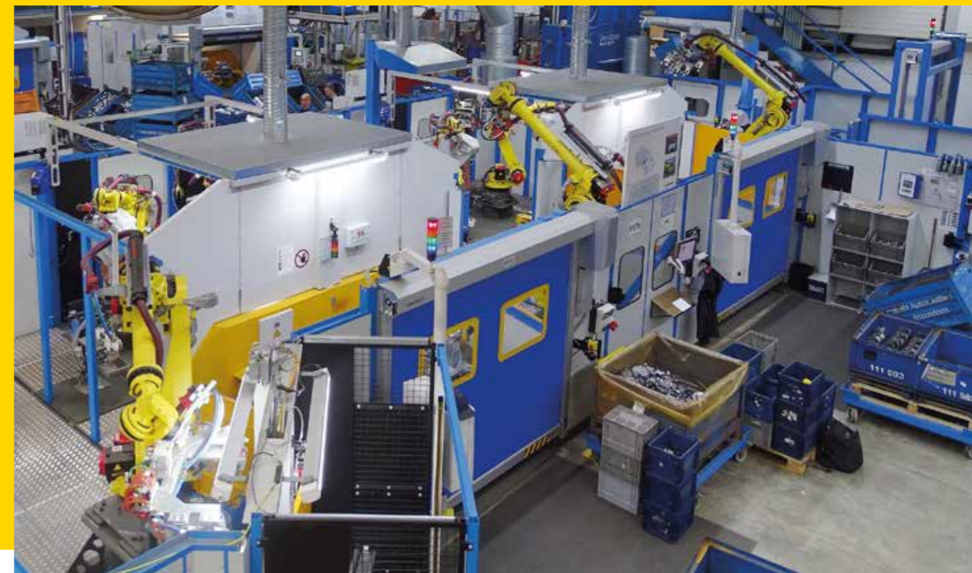
Eine der neuen Schweißanlagen für die VW MEB Plattform im Werk Attendorf
