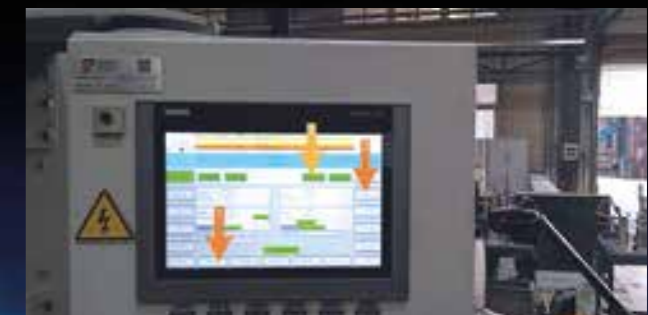
Online-Ansicht des Spezialisten auf die Umgebung des Anwenders. Der Spezialist kann visuelle Hinweise einfügen, welche mittels der Brille direkt in das Sichtfeld des Anwenders projiziert werden.
