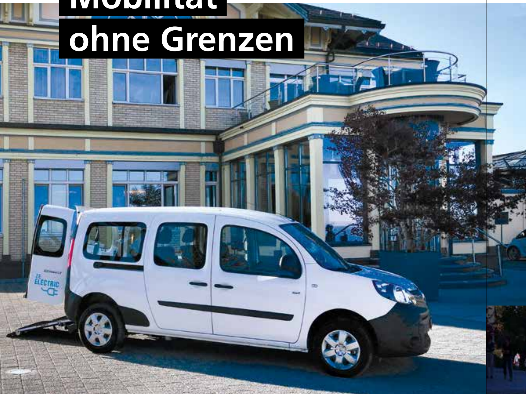
Ein von KIRCHHOFF Mobility umgebauter Renault E-Kangoo mit Heckausschnitt.
