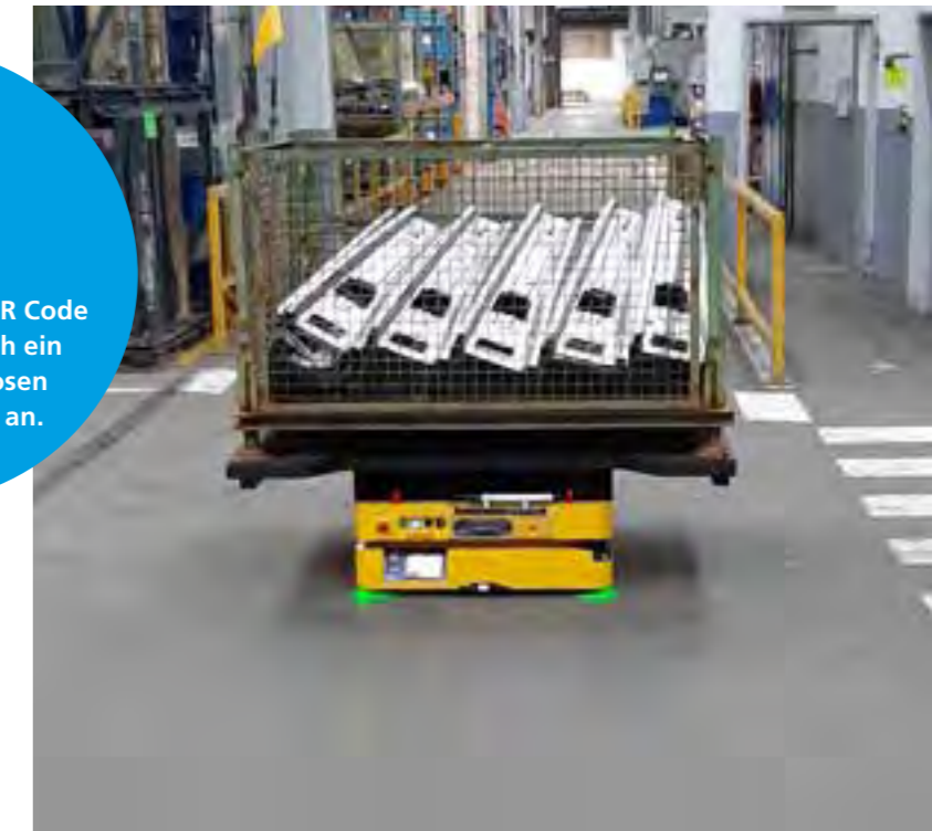
Oben: Attendorn: Ein FTS transportiert Fertigteile aus der Produktion in den Versand. Links: Fahrerlose Transportsysteme im Werk Cucujães, Portugal.
