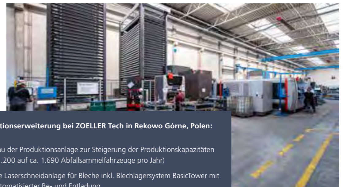
Laserschneidanlage für Bleche inkl. vollautomatischer Be- und Entladung und BasicTower
