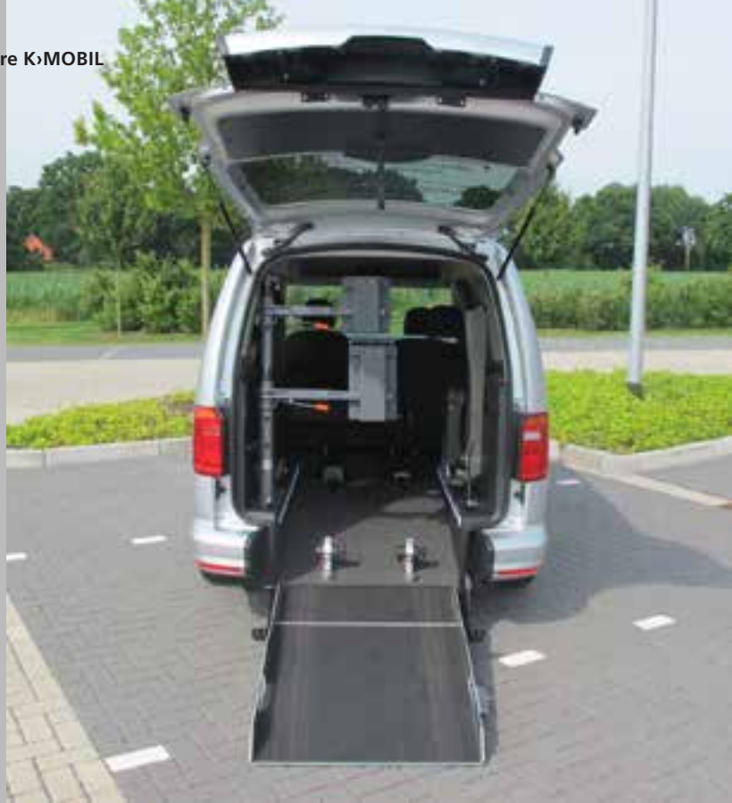
Eines der Kernprodukte von KIRCHHOFF Mobility: Der Heckausschnitt NIVO, hier im VW Caddy. Auf diesem Bausatz basieren behindertengerechte Umbauten für diverse Hochdachkombi Modelle.
