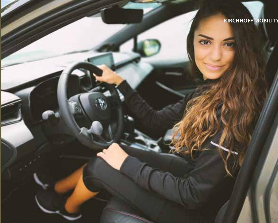
Abassia in ihrem Toyota Corolla Hybrid mit Handbediengerät Carospeed für Gas und Bremse, Lenkraddrehknopf Ergo und Pedalabdeckung
