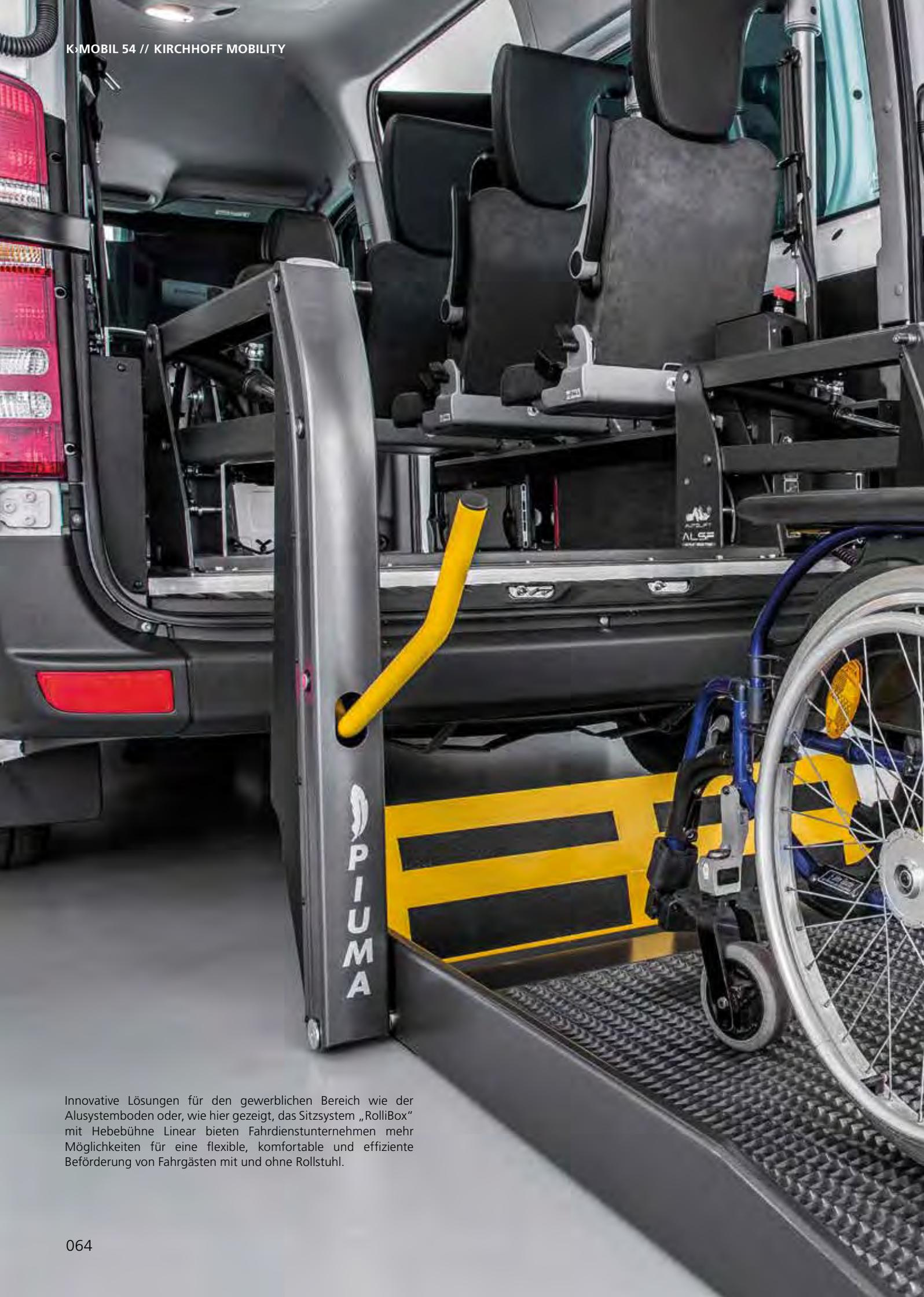
Innovative Lösungen für den gewerblichen Bereich wie der Alusystemboden oder, wie hier gezeigt, das Sitzsystem „RolliBox“ mit Hebebühne Linear bieten Fahrdienstunternehmen mehr Möglichkeiten für eine flexible, komfortable und effiziente Beförderung von Fahrgästen mit und ohne Rollstuhl.
