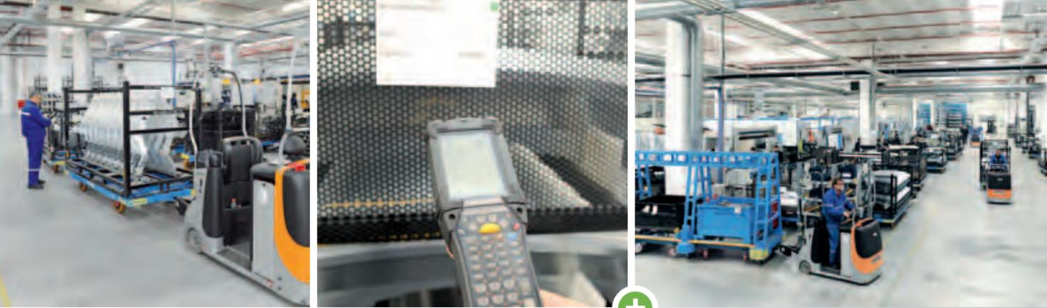
links: Versandlagerbereitstellung der Fertigteile mit dem Milkrun Prozess; mitte: Versandlager-Scannererfassung der Fertigteile; rechts: KANBAN gesteuerte Milkrun-Einzelteilversorgung der Schweißzellen
