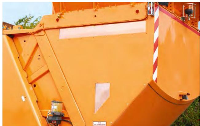
**Oben:** Ohne Umrüstung kann der Ladekran auch ältere Depotcontainer mit zwei Ringsystem aufnehmen und leeren. **Unten links:** Der Schieber für den Handeinwurf wird pneumatisch angesteuert. **Unten rechts:** Sichtfenster am Aufnahmetrichter erleichtern die Kontrolle eines ordnungsgemäßen Ladevorganges bzw. helfen Verstopfungen frühzeitig zu erkennen.
