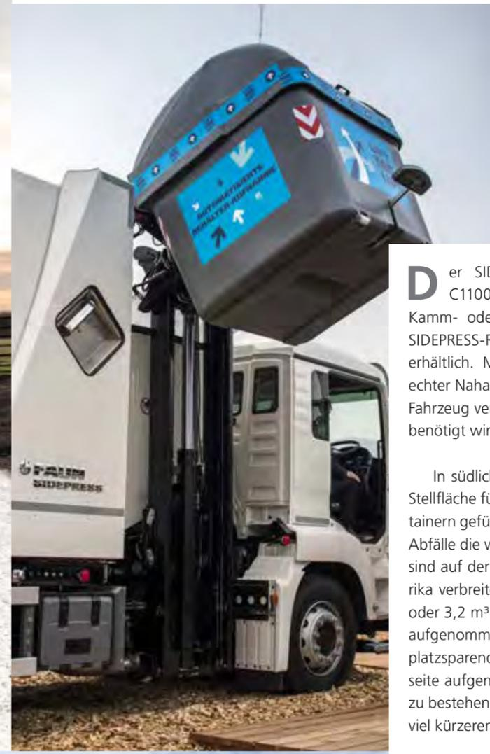
Der SIDEPRESS C1100 mit bewährtem Kreisbogen-Lifter C1100 für die Abfuhr von 60 bis 1.100 l Gefäße über Doppelkamm- oder Doppel-Diamond-Aufnahme ist der Klassiker der SIDEPRESS-Reihe. Beide Aufnahmen sind als Umstecklösung erhältlich. Mit der Variante C1100 vertical steht ein Lifter mit echter Nahaufnahme zur Verfügung. Die Behälter werden eng am Fahrzeug vertikal geliftet und entleert, so dass seitlich wenig Platz benötigt wird.
