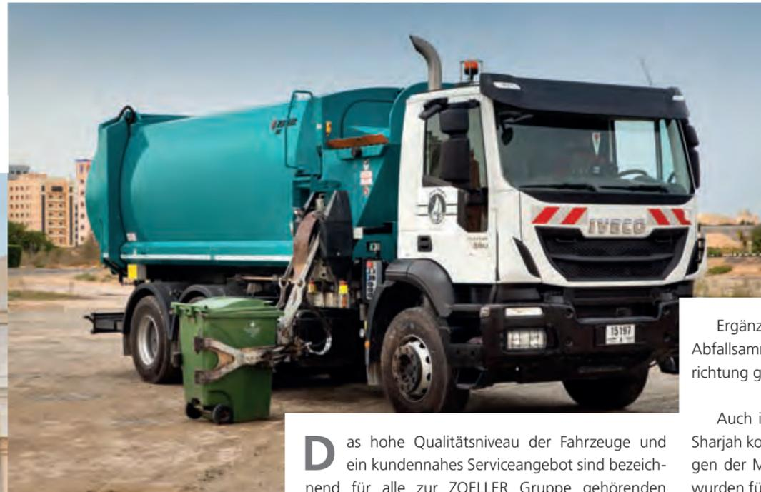
SLF Seitenlader mit einem Behältervolumen von 22 Kubikmetern
