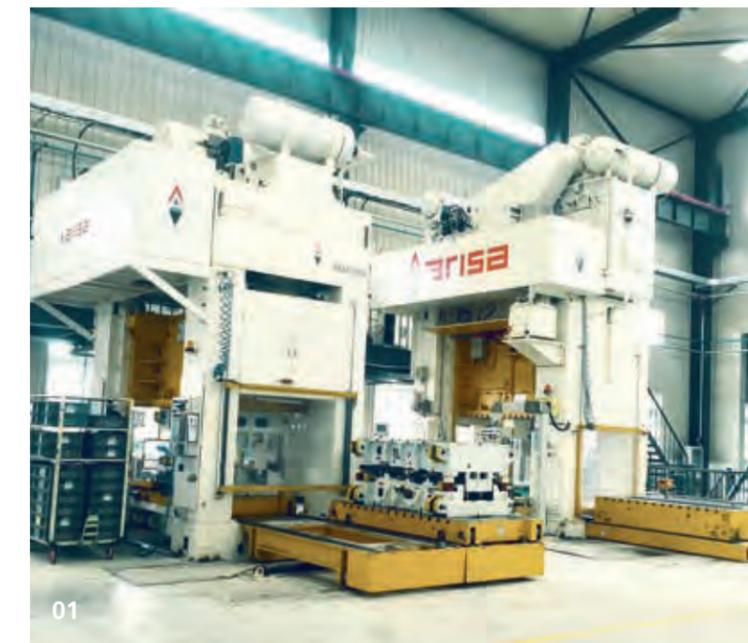
01 Auf zwei neu installierten Pressen werden zukünftig Aluminiumteile gepresst.
