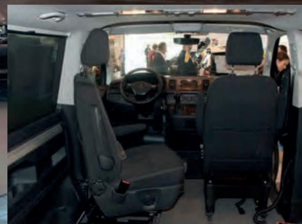
Im Volkswagen T6 Multivan Colorado zeigte KIRCHHOFF Mobility weitere Umbaumöglichkeiten für Aktiv- und Passivfahrer: einen von der A- bis zur C-Säule um mehr als 130 mm abgesenkten Boden, einen Einstieg über einen Kassettenlift sowie einen geprüften Spezialrollstuhl, der als Fahrer- oder Beifahrersitz genutzt werden kann. Im Heck wurde zudem ein Lift verbaut, um einen Scooter oder ähnliches leicht verladen zu können.
