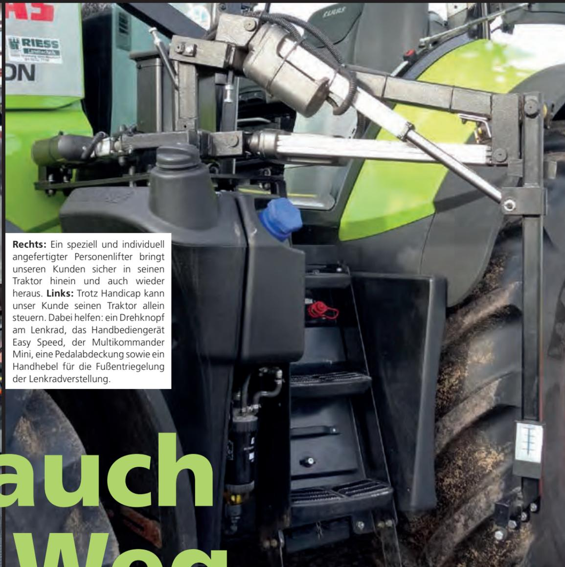
**Rechts:** Ein speziell und individuell angefertigter Personenlifter bringt unseren Kunden sicher in seinen Traktor hinein und auch wieder heraus. **Links:** Trotz Handicap kann unser Kunde seinen Traktor allein steuern. Dabei helfen: ein Drehknopf am Lenkrad, das Handbediengerät Easy Speed, der Multikommander Mini, eine Pedalabdeckung sowie ein Handhebel für die Fußentriegelung der Lenkradverstellung.
