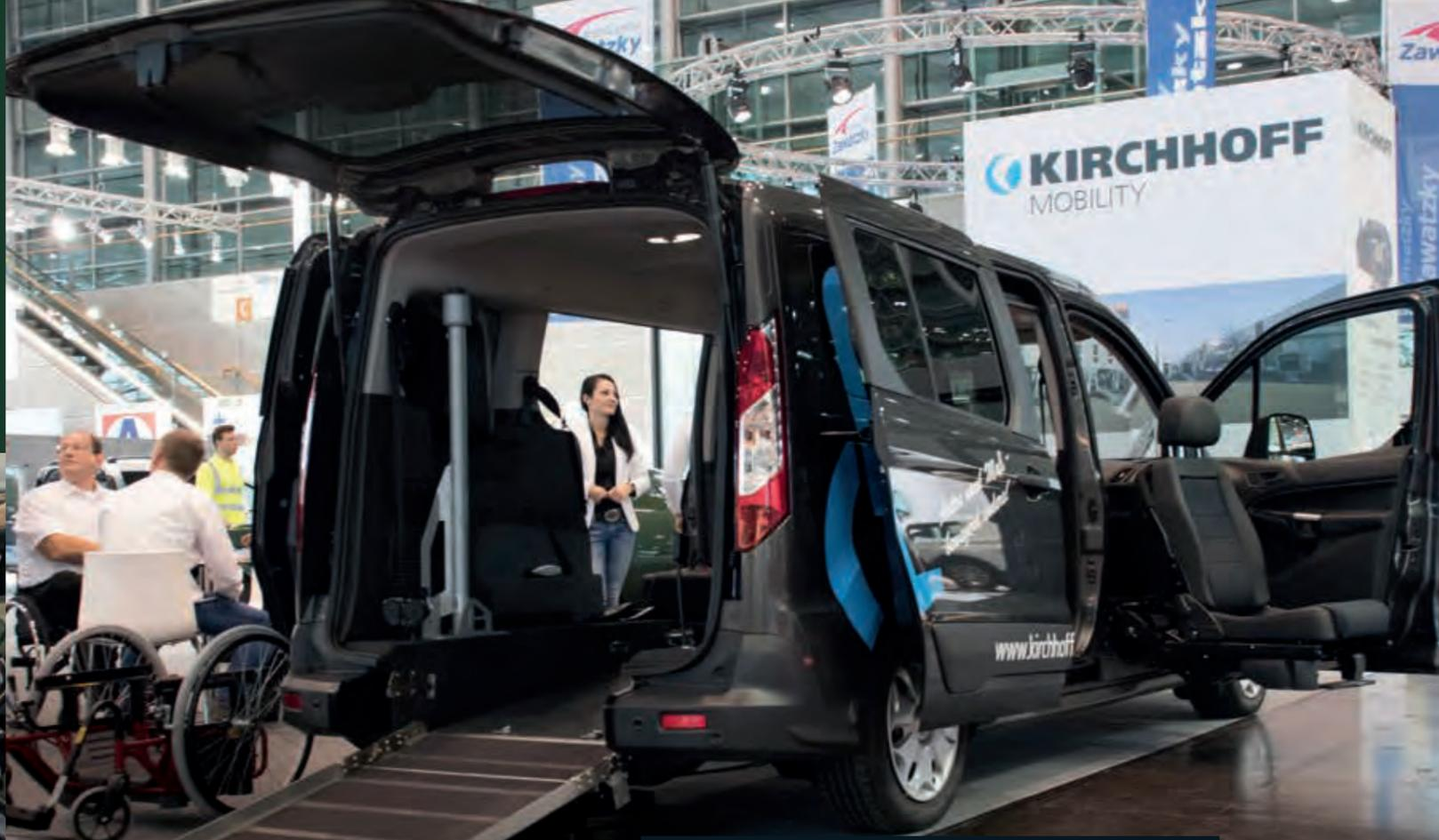
Der Ford Grand Tourneo Connect wurde mit einer schwereleosen Flex-Rampe (SFL-Rampe) ausgestattet. Der Rollstuhlfahrer kann über das Heck hineinfahren und ohne anstrengendes Umsetzen seine Fahrerposition einnehmen.
