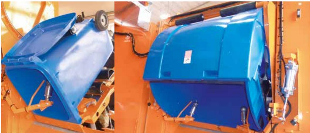
Es werden ca. 3 Liter Wasser pro 2-Rad-Gefäß verbraucht. Die Waschzeit ist stufenlos einstellbar - wählbar ist ein kurzes oder langes Waschprogramm. Zudem besteht die Möglichkeit, die Behälter mit Kaltwasser oder Warmwasser zu waschen. Automatische und verschleißfrei arbeitende Schmutzwasserpumpe. Automatische Reinigung des Sammelkastenbodens und des Schmutzwassertanks.
