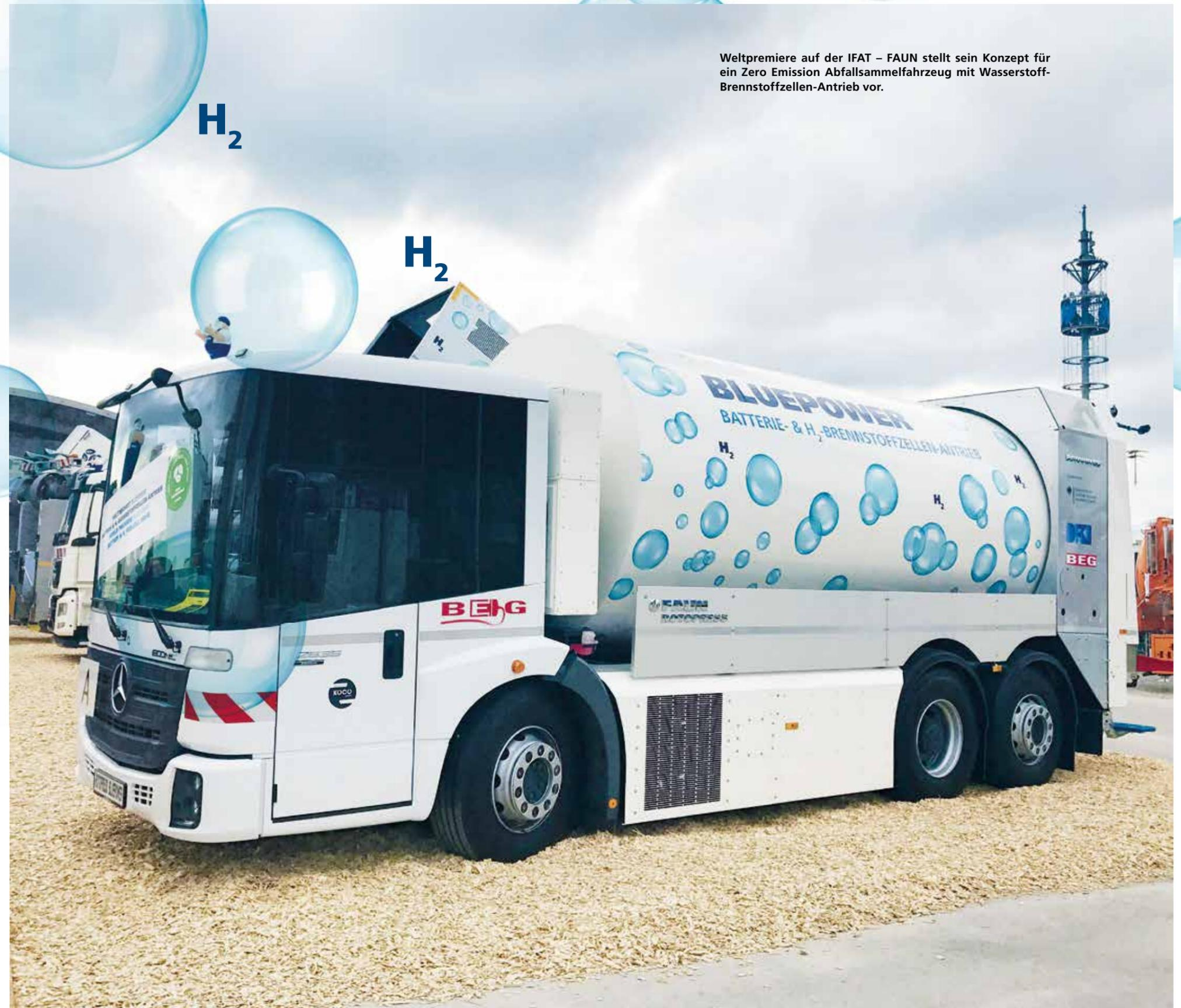
Weltpremiere auf der IFAT – FAUN stellt sein Konzept für ein Zero Emission Abfallsammelfahrzeug mit Wasserstoff-Brennstoffzellen-Antrieb vor.
