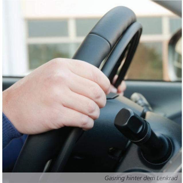
Gasring hinter dem Lenkrad
